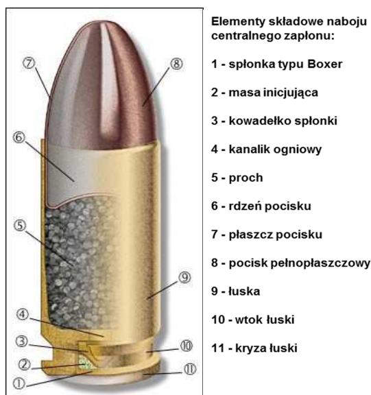
Rys. 40. Budowa naboju strzeleckiego
